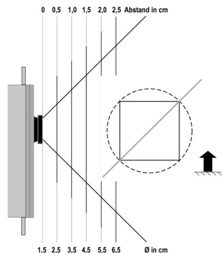
Abb. 1: Montage hinter Schutzglas
